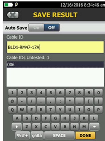
通过电容触摸屏快速输入线缆 ID
