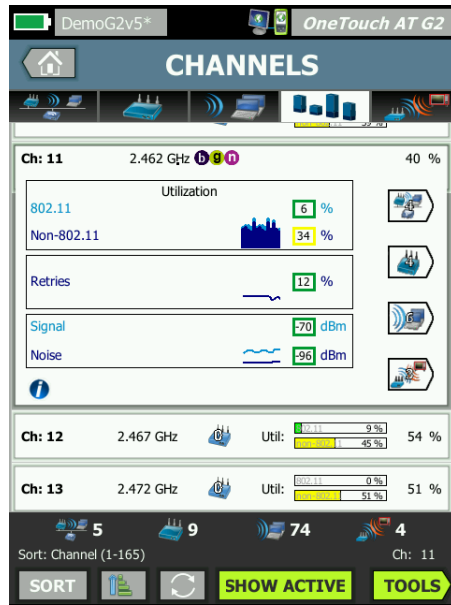
图 14.分析各 Wi-Fi 信道，显示 802.11 和非 802.11 流量占用的带宽
