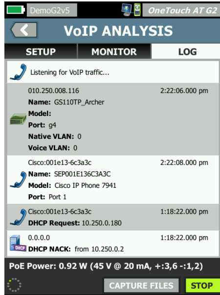
图 18.VoIP 分析显示整个呼叫设计过程以及各个方向的 VoIP 呼叫质量
